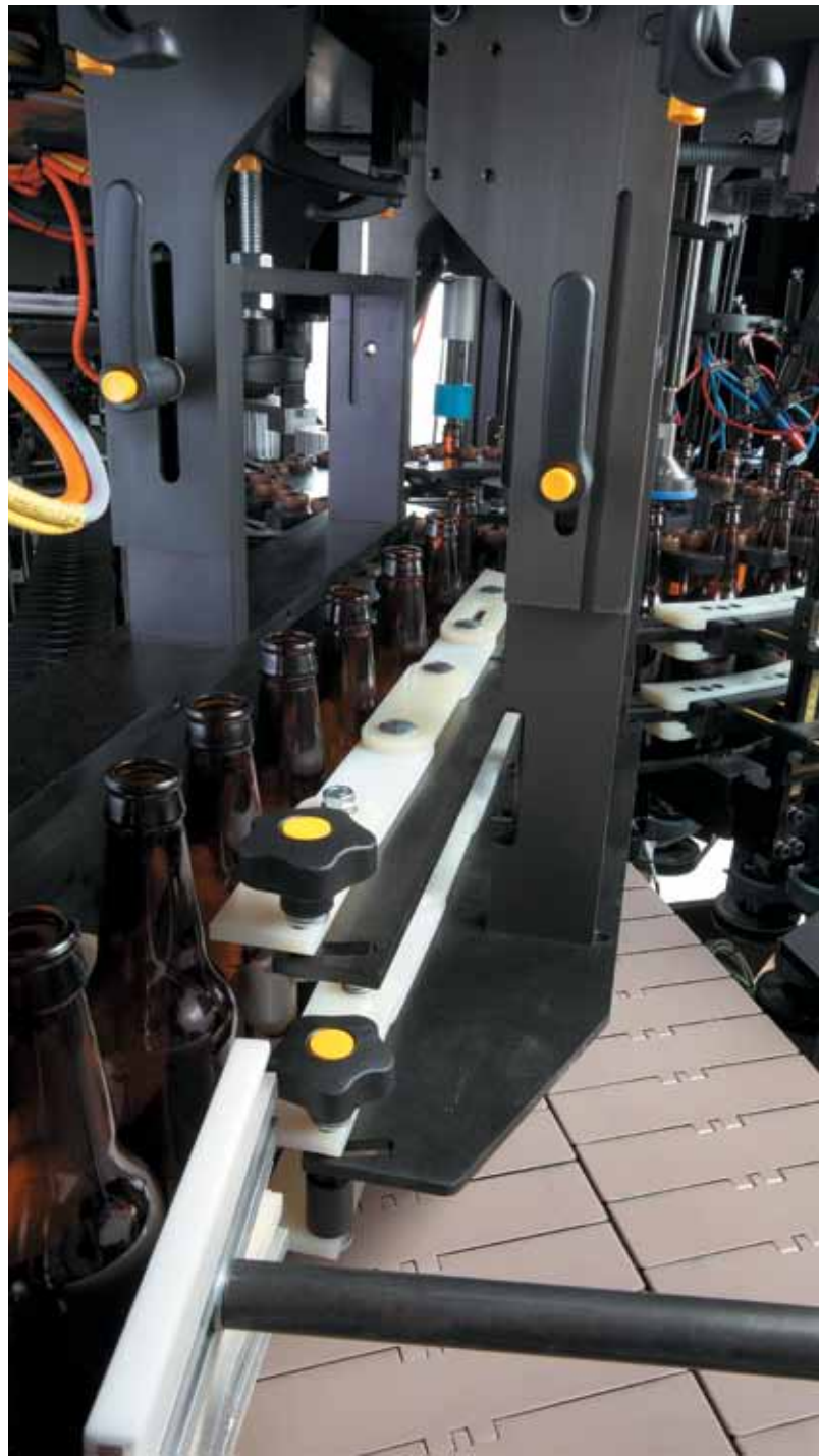
Подающий винт, недавно созданной установки типа M. Угол в 30° обеспечивает стабильность контроля тары.
